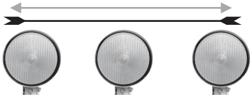
Signální program 3 uzavření jízdního pruhu blikající všechna návěstidla
